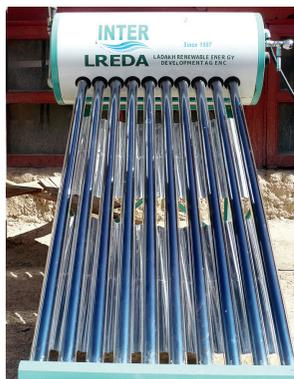
Das indische Produkt besteht aus einem 100 l Wassertank, mit dunklen, schräg nach unten führende Glasröhren. Kaltes Wasser wird in den Tank eingefüllt, die Röhren füllen sich und werden durch die Sonneneinstrahlung erwärmt, das heiße Wasser steigt hoch in den Tank, wo es mittels eines Drehhahns entnommen werden kann.
